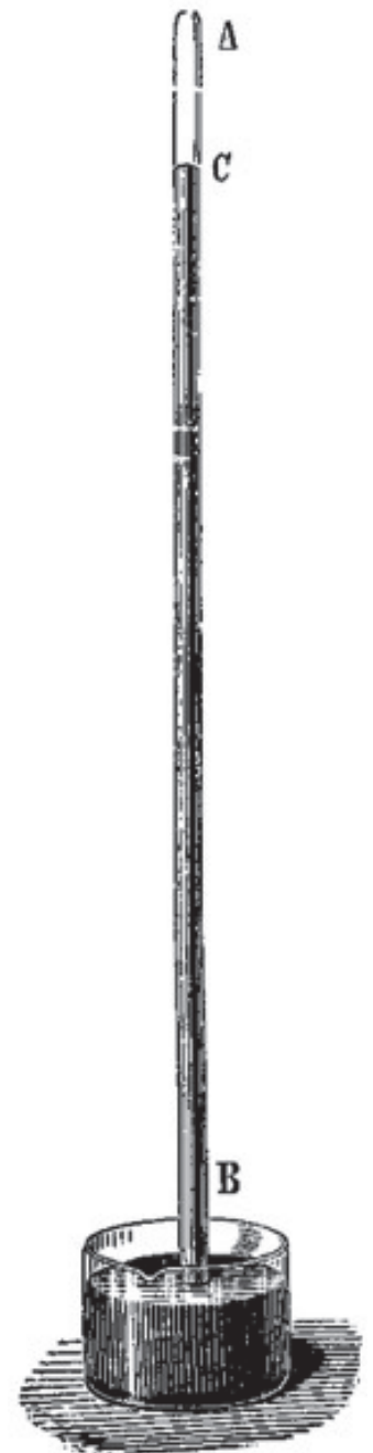
Abb. 2: Torricellis erstes Barometer. Zwischen A und C hat sich ein Vakuum gebildet.
